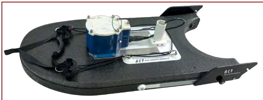
Planche intégrant un ADCP TRDI StreamPro (version spéciale sans les poignées de transport habituelles)
