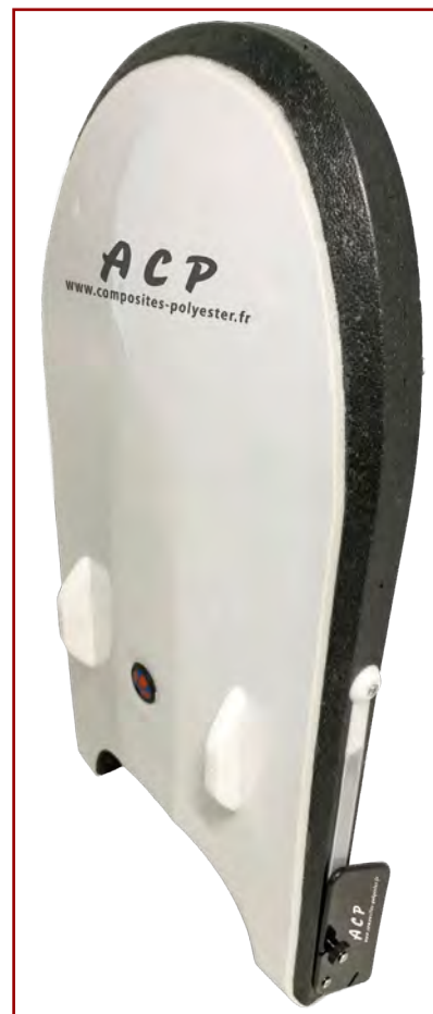
Planche intégrant un ADCP TRDI StreamPro
